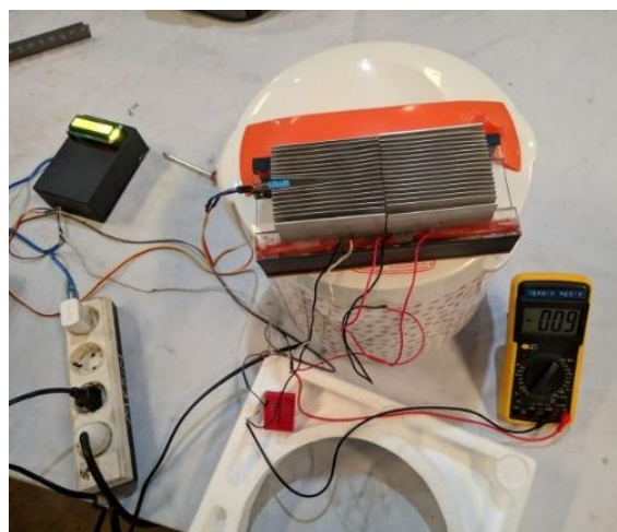
Gambar 5. Pengujian magic com dengan TEG
