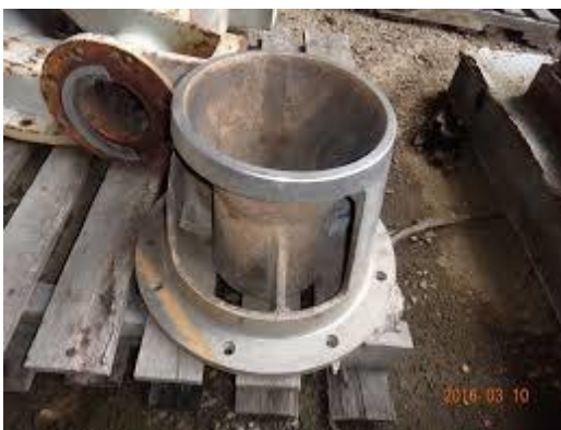
Gambar 7. Cone yang sudah korosi dan harus diganti
