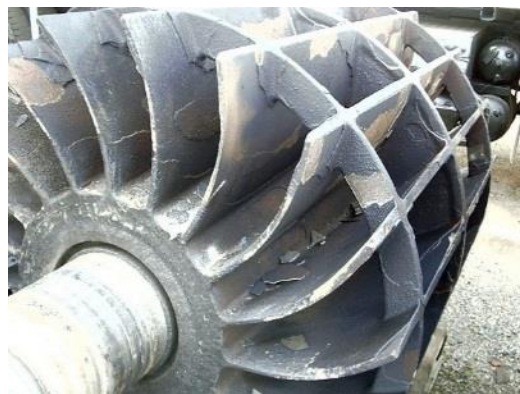
Gambar 8. Gambar impeller First Stage yang keropos
