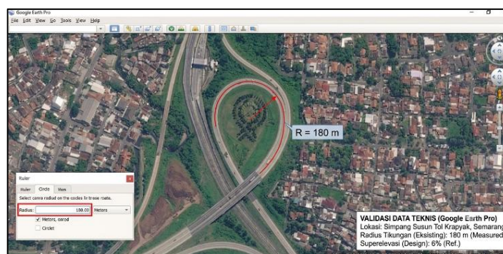
Gambar 1. Pengukuran Radius Tikungan pada Ramp Simpang Susun Tol Krapyak
