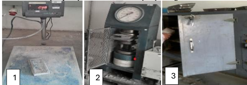
Gambar 4. Uji Kuat Tekan dan Penyerapan air Sampel Paving Block: 1. Penimbangan paving block, 2. Pengukuran kuat tekan 3. Pengeringan di oven
