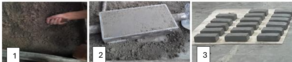
Gambar 3. Desain Campuran Variasi Paving Block: 1. Pencampuran material, 2. Pencetakan sampel, 3. Paving block sampel
