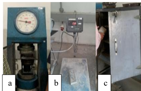
Gambar 4. Uji Kuat Tekan dan Absorpsi Paving Block
