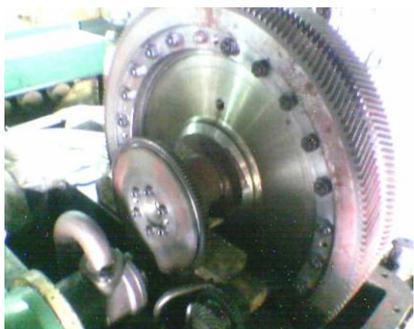
Gambar 14. Kopling yang digunakan pada PLTU Muara Karang unit 5.
