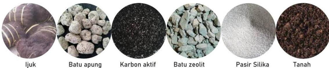
**Gambar 3.** Komposisi filterisasi Tangki Bioretensi
