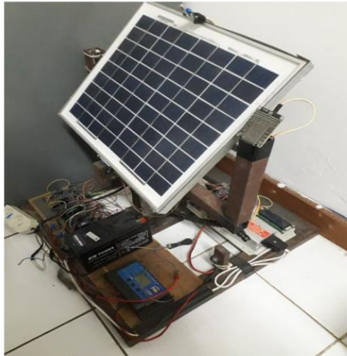
Gambar 4. Prototipe Pembangkit Listrik Tenaga Surya dengan Smart Tracker untuk Mendukung Pengairan Lahan Kering
