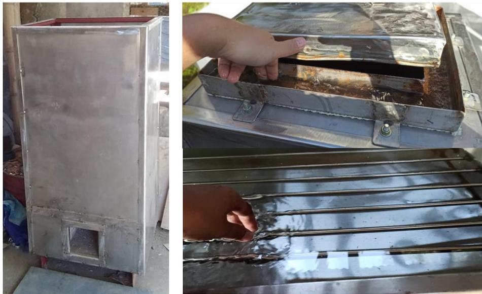
Gambar 2. Gasifier Tanpa Blower, Air Isolator pada Reaktor, dan Pipa Cooler
