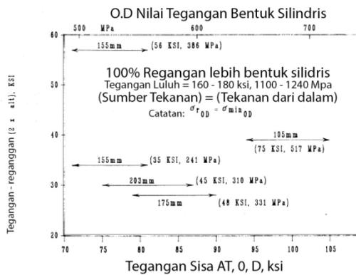
**Gambar 4:** Daerah tegangan pada Permukaan luar silinder
